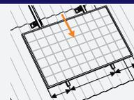
**⚠ Achtung:** Kabel im Kabelclip einrasten lassen und Solarmodul bis zur Unterkante der Schiene schieben.
