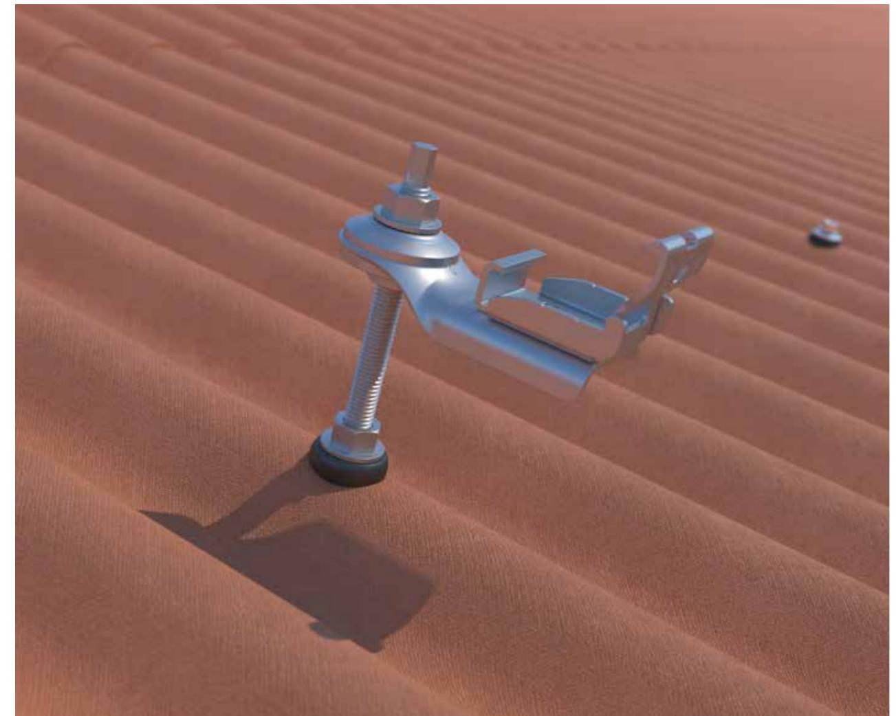
Esdec hat die passende Klemme für die gängigsten Stehfalzdachtypen, für Einfach- oder Doppelstehfalz, Klick- und Rundstehfalzdächer. Die patentierten S-5! Klemmen sind die Basis für unser Montagesystem. Je nach Falzanschlusstyp wählen Sie die passende Klemme, auf der die Klickverbindung bereits montiert ist. Sie müssen die Klemme nur noch mit der Torx-Schraube auf die Stehfalz schrauben.
