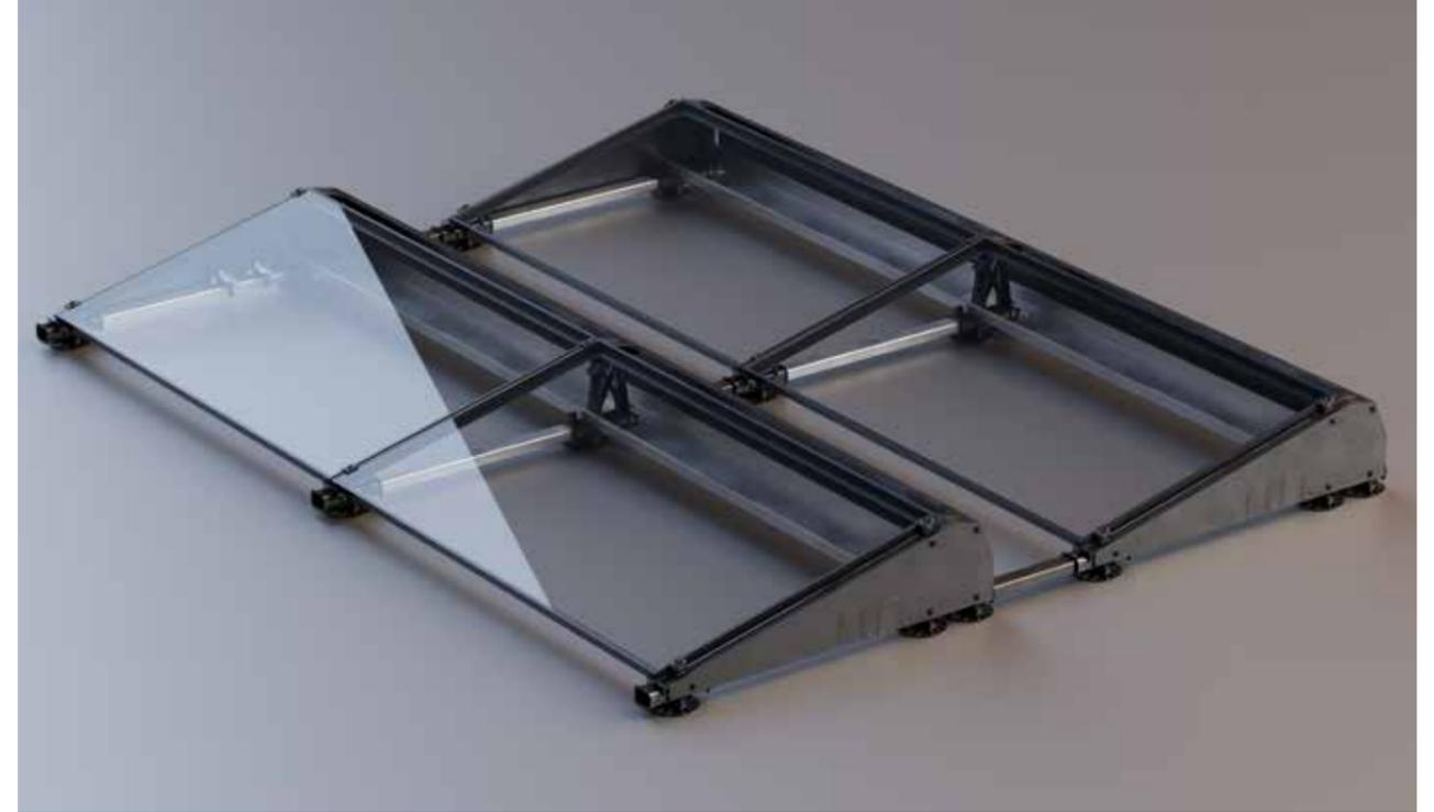
Die Verwendung von Winddeflektoren auf der Rückseite und an den Seiten des Systems sorgt für einen aerodynamischen und ästhetischen Abschluss des Systems. Der Stabilisator verbindet die verschiedenen Segmente in der Breitenrichtung und sorgt so für zusätzliche Stabilität in einer Doppelanordnung.
