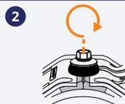
2. Apriete el tornillo hasta que el sellado de EPDM del soporte y la junta de goma del tornillo se toquen.
