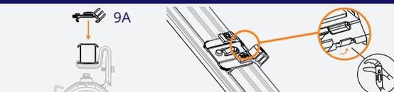
**¡Atención!** Coloque los clips a una distancia aproximada de 1 m entre sí y por debajo del centro del panel.
