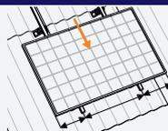
**⚠ ¡Atención!** Apriete los cables con un clic en el clip sujetables y deslice el panel hacia la parte inferior del riel.
