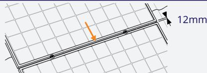
**⚠ ¡Atención!** Asegúrese de que la separación sea de 12 mm y de que los paneles solares estén derechos antes de apretar el tornillo.
