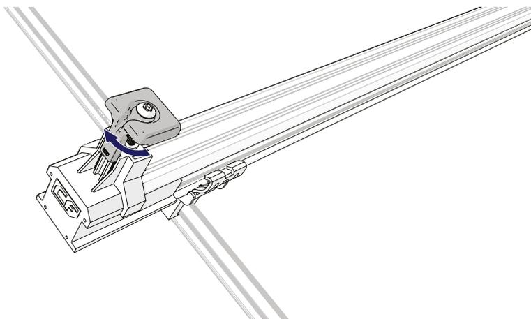
**6 OPCIONAL: GUÍE LOS CABLES DEL PANEL SOLAR A TRAVÉS DE LAS CONEXIONES DE CLIC.**
