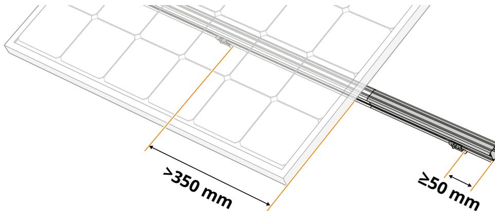
b. Si el saliente calculado es inferior a 250 mm más allá de la posición marcada de la última abrazadera de costura, mantenga un saliente de 20-35 mm de longitud del riel para montar la tapa del extremo (art. no. ) (>40 mm para la abrazadera ClickFit EVO de 60 mm).
