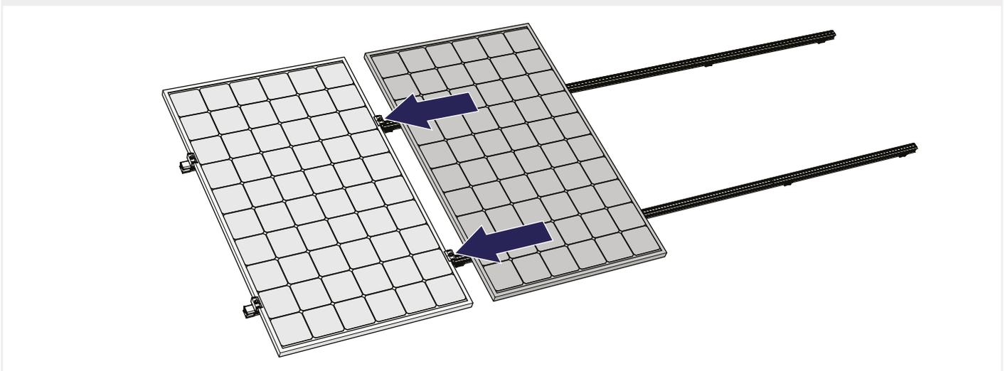
3 FIJE EL TORNILLO DE LAS CLEMAS/GRAPAS FINALES PARA ASEGURAR EL PANEL. APLIQUE UN PAR DE 16,5 NM.
