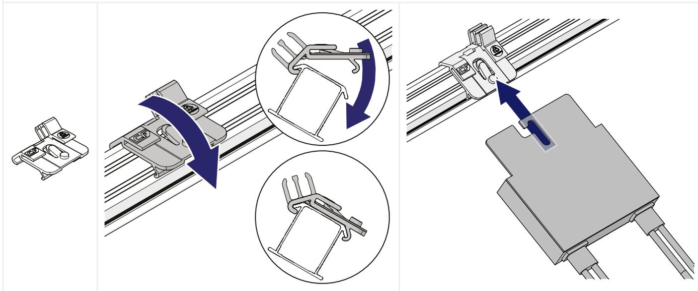
**i** Con la orientación del riel vertical, debe fijar el clip MLPE doblando el borde del riel de montaje con unos alicates ajustables.
