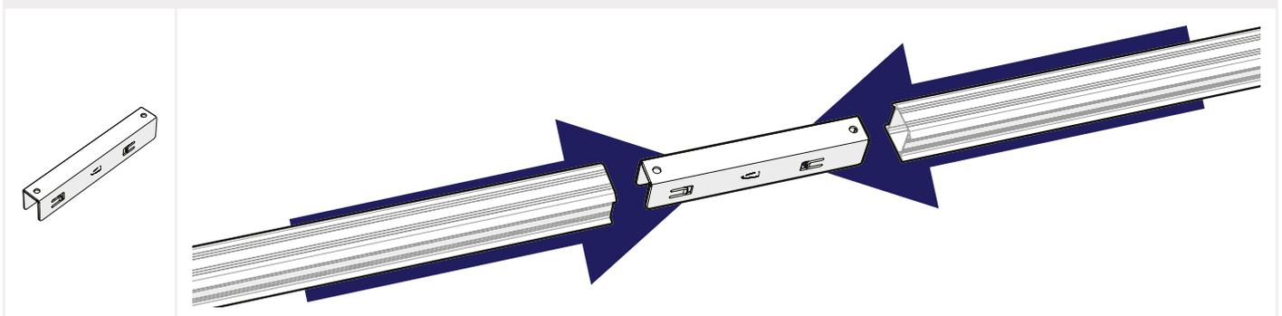
**5 SI EL SALIENTE ES SUPERIOR A 250 MM: EXTIENDA EL RIEL DE MONTAJE HASTA LA SIGUIENTE BRIDA.**
