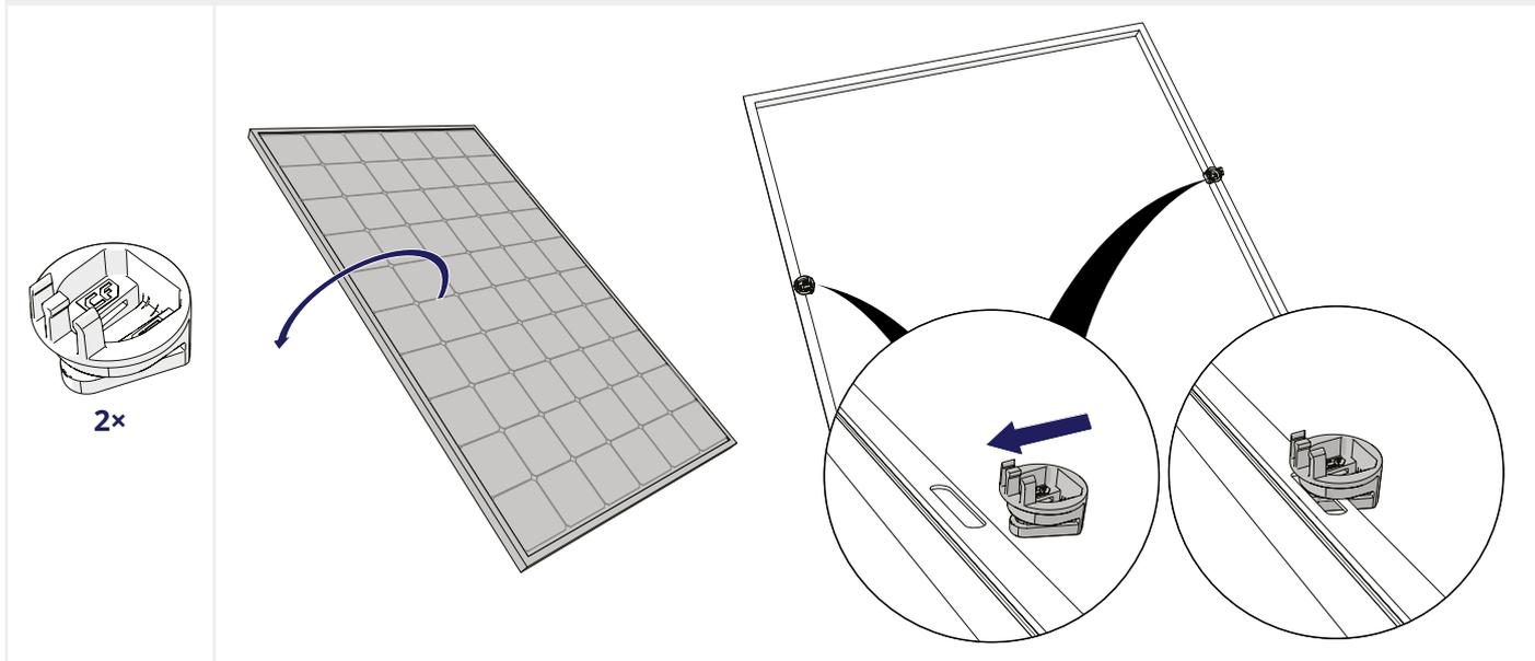
2 OPCIONAL: ACOPLA LOS CABLES DEL PANEL FIRMEMENTE EN EL INTERIOR DE LA GRAPA DE CABLE.
