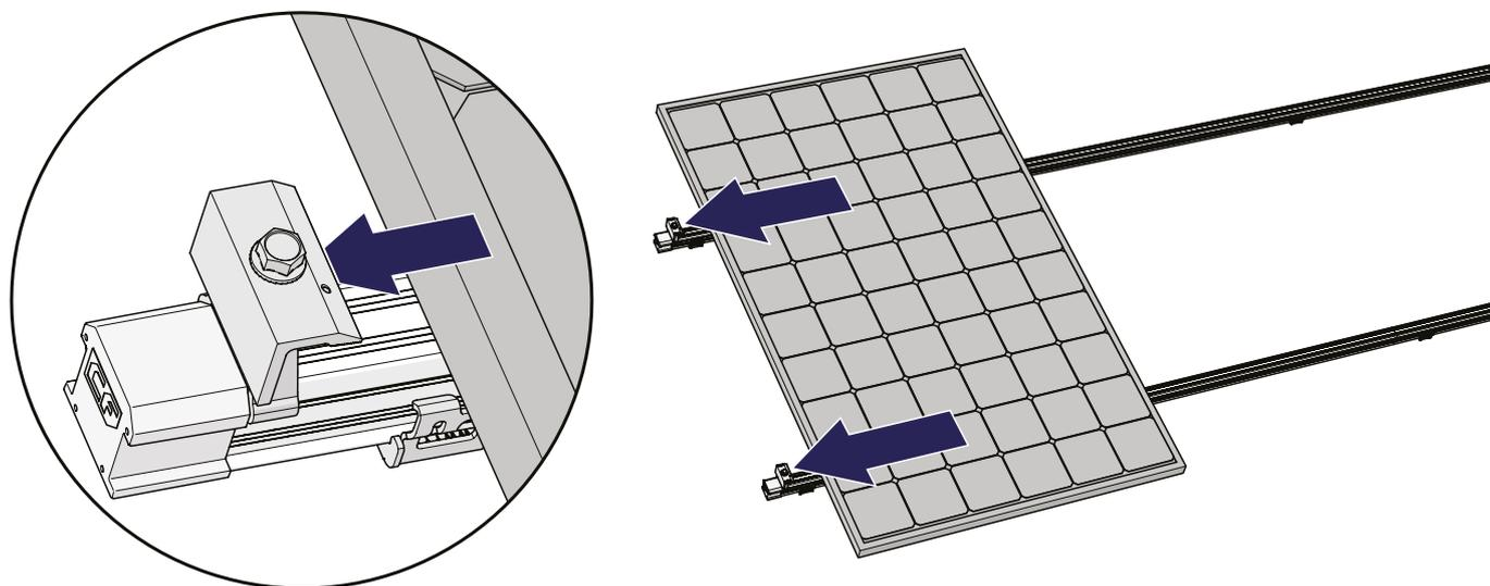
**7 FIJE EL TORNILLO DE LAS CLEMAS/GRAPAS FINAL PARA ASEGURAR EL PANEL. APLIQUE UN PAR DE 16,5 NM.**
