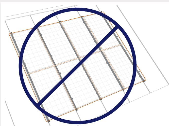
⚠ Se desaconseja el montaje de los paneles solares combinando las orientaciones vertical y horizontal de los rieles. La calculadora tampoco admite este método de montaje.
