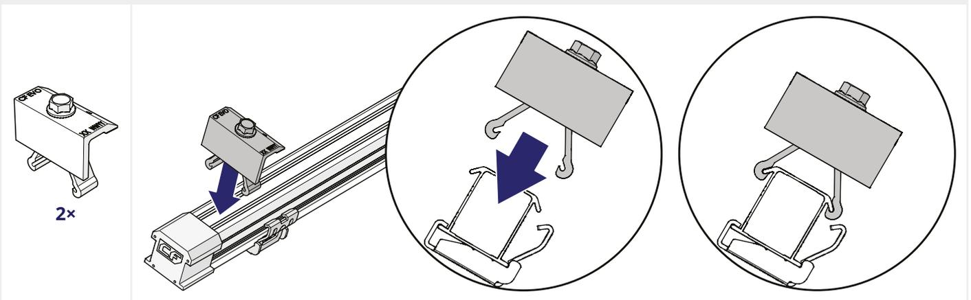
**5 OPCIONAL: GUÍE LOS CABLES DEL PANEL SOLAR A TRAVÉS DE LAS CONEXIONES DE CLIC.**
