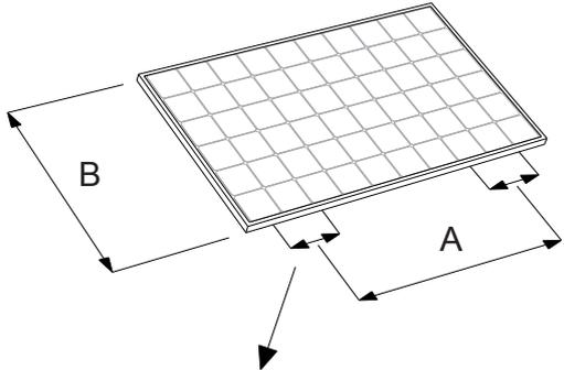
Zone de serrage spécifiée par le fabricant du module
